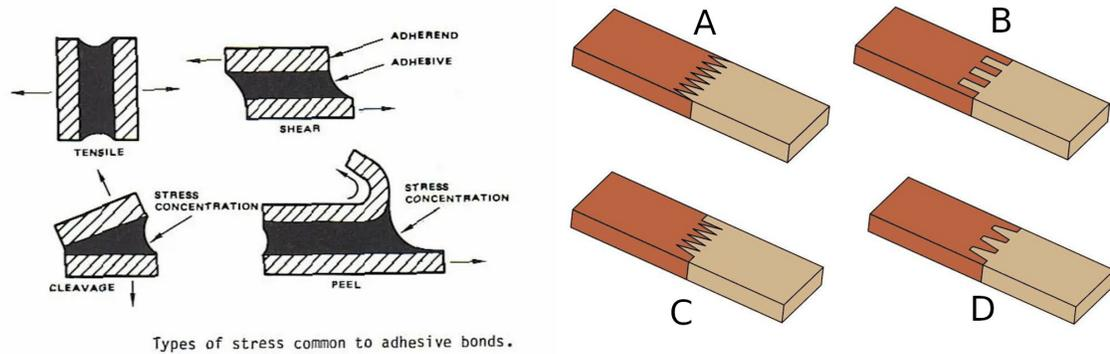
**Figura 2:** A la izquierda en la imagen en blanco y negro, los tipos de tensiones en la unión pegada. A la izquierda, en la fila superior, la tensión normal de tracción (Tensile) y a la derecha la tensión de cizalladura (Shear). A la derecha, en la imagen en color, métodos para repartir las tensiones normales sobre una superficie mayor y en más componentes.
