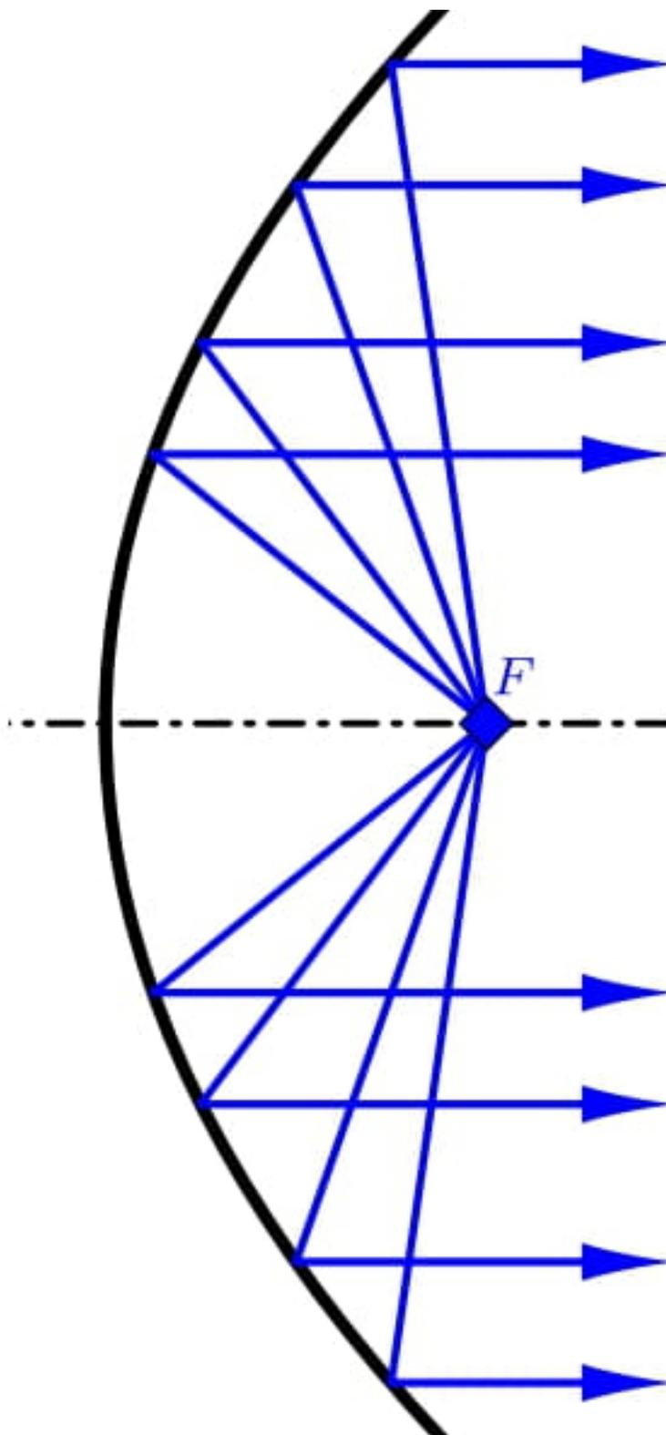
Figura 1: Corte de antena parabólica
